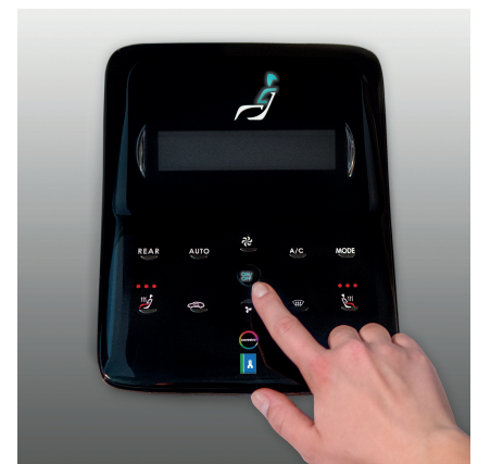
Bild 4. Der Demonstrator für das Bedienpanel einer Mittelkonsole mit induktiven Tastenfunktionen wurde im DC-Prozess durch Hinterspritzen einer bedruckten Makrofol-PC-Folie hergestellt und die Oberfläche mit einem Tiefenglanz auf Basis von Puroclear veredelt
